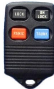
1) Gire o contato de OFF para ON (quando as luzes do painel se acendem) por 5 vezes dentro de 10 segundos, sendo que na 5ª vez você deve parar a chave em ON. O módulo travará e destravará as portas confirmando a entrada no modo de programação.
